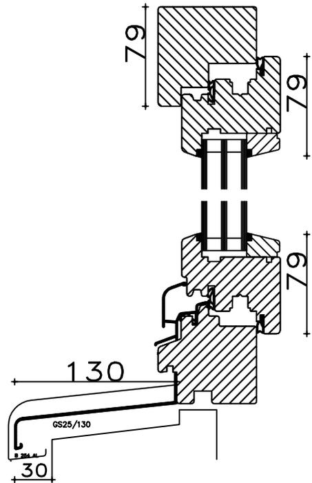
Les tablettes pour fenêtre sont insérées de 15 mm dans le dormant bas. En tenir compte pour le calcul de profondeur des tablettes.
