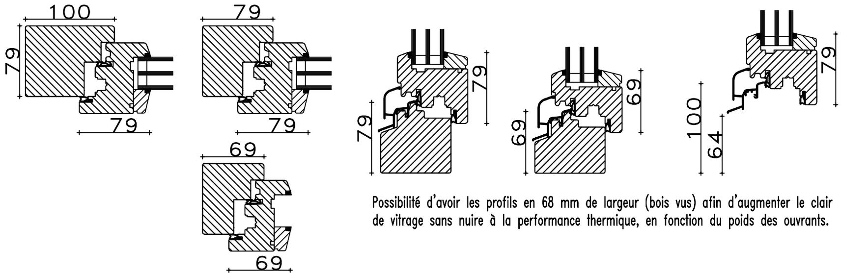
Possibilité d'avoir les profils en 68 mm de largeur (bois vus) afin d'augmenter le clair de vitrage sans nuire à la performance thermique, en fonction du poids des ouvrants.
