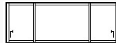
Modèle K Les 2 vantaux latéraux coulissent sur 1 central
